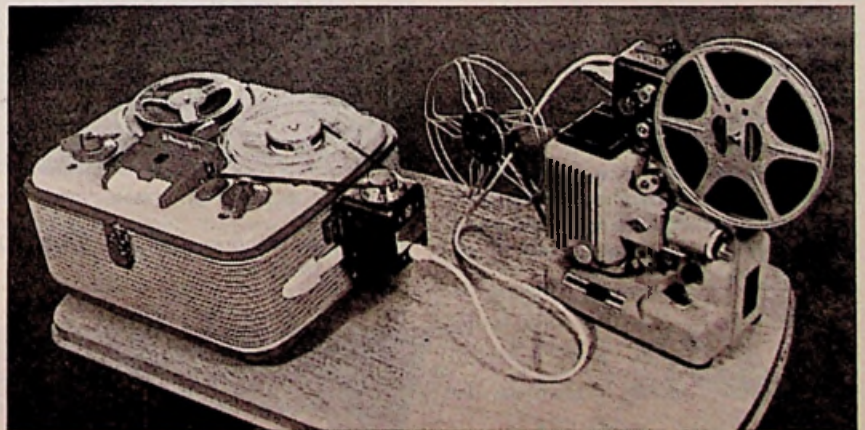
Opstelling van een geluidsfilminstallatie volgens het Metaf „Synchro-box“-systeem. Projector en bandspeler zijn slechts door één electrisch kabeltje verbonden. Synchronisatie is absoluut.
